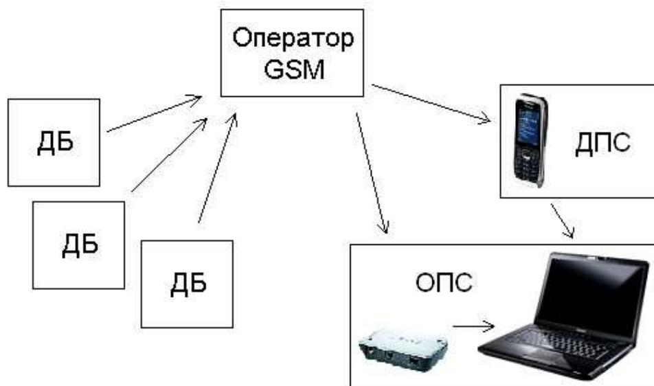
**Р и с. 1.** Структурная схема измерительно-информационной системы на основе прибрежных минидрифтеров
