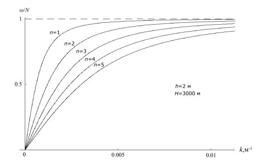
Дисперсионные кривые для внутренних волн Кельвина под ледяным покровом постоянной толщины h=2 м (n — номер моды; глубина океана H=3000 м; частота Брента — Вяйсяля  $N=0{,}001$  с $^{-1}$ )
