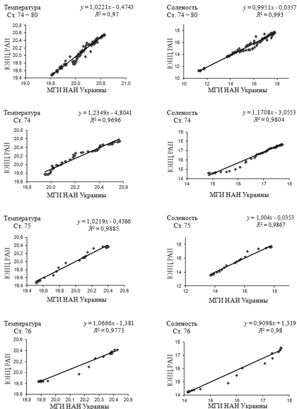
**Р и с. 2.** Корреляционные зависимости температуры и солености по данным СТД-зондов МГИ НАН Украины и ЮНЦ РАН на интеркалибрационных станциях
