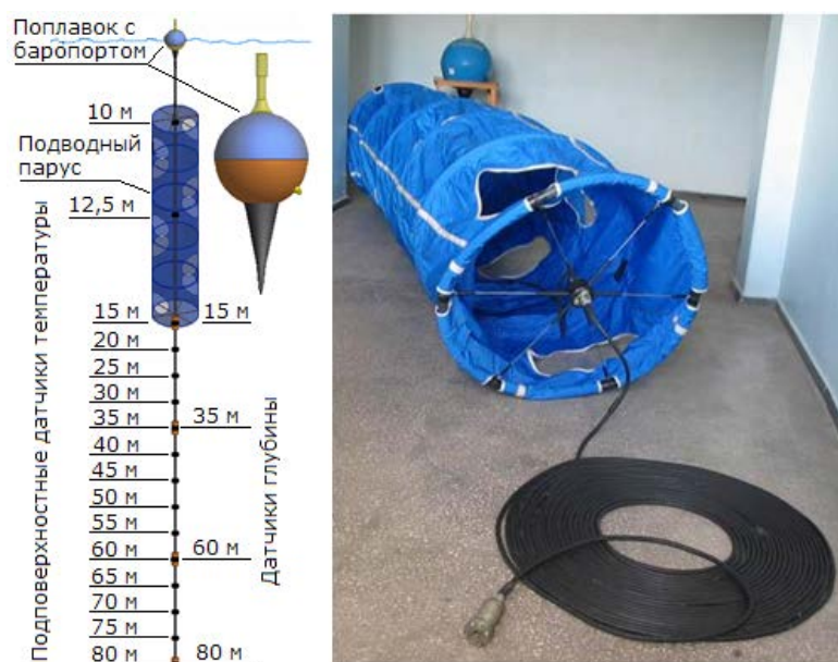
Р и с. 1. Структура (слева) и внешний вид (справа) термодрифтера SVP-BTC80RTC/GPS
