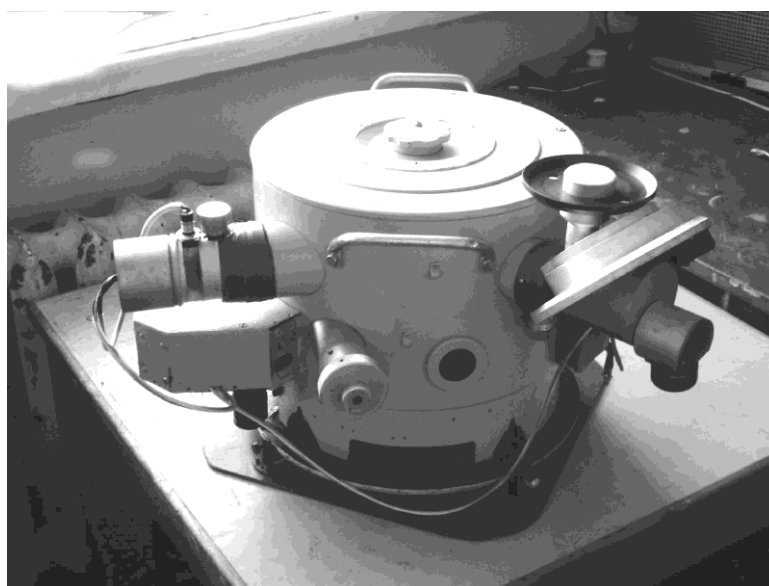
Рис. 1. Спектрофотометр для измерений коэффициента яркости моря
