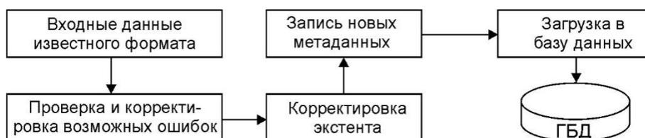
Рис. 6. Структурная схема загрузочного модуля системы
