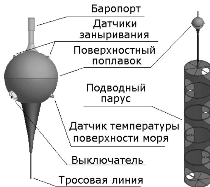
Рис. 6. Структура SVP-B дрейфующего буя
