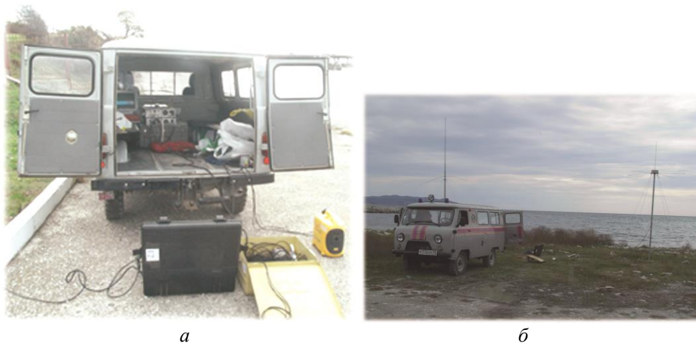
Рис. 1. Размещение измерительного оборудования в микроавтобусе (а) и пример расположения радиолокационных антенн на береговой линии (б)
