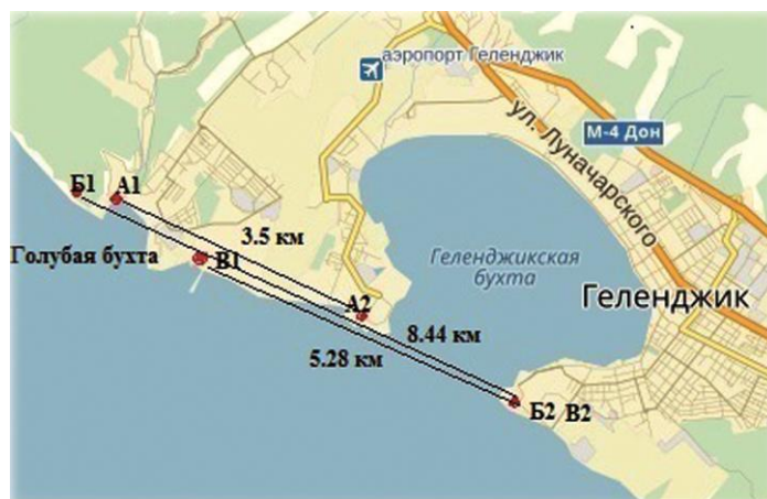
Рис. 2. Расположение точек установки радиолокационных антенн на береговой линии при измерениях 19 – 21 октября. Точки А1 и А2 – 19 октября, точки В1 и В2 – 20 октября, точки В1 и В2 – 21 октября
