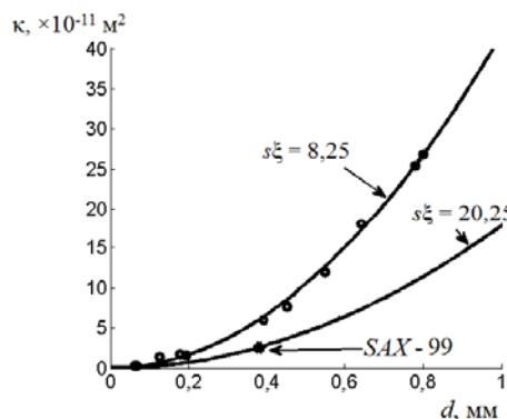
Рис. 2. Гидравлическая проницаемость среды в зависимости от диаметра гранул
