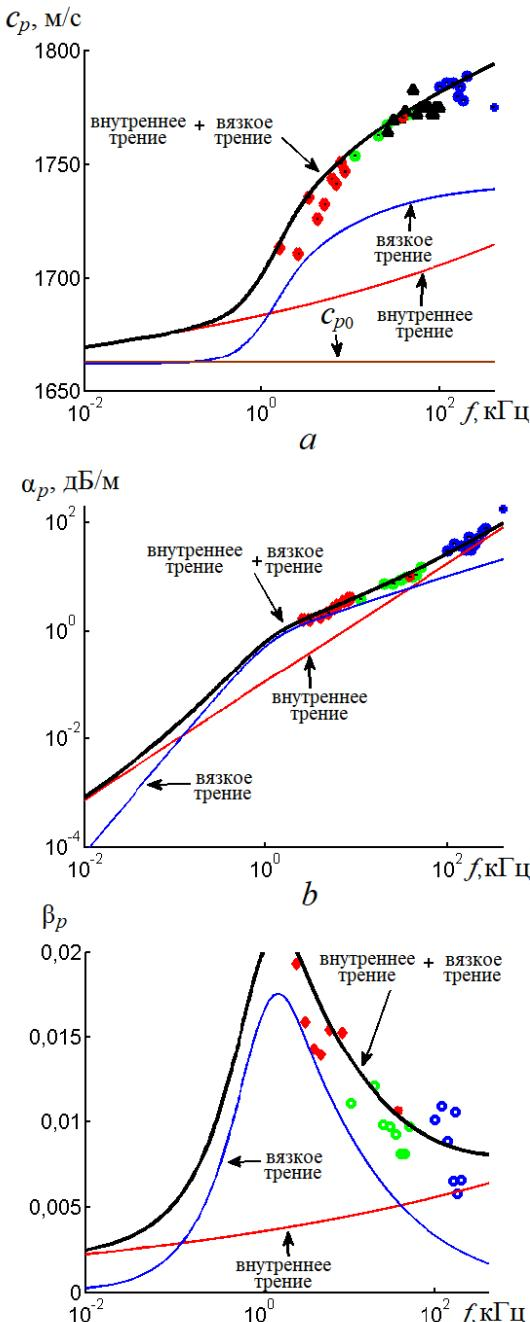
**Р и с. 4.** Частотные зависимости скорости звука (а), коэффициента затухания (б), тангенса потерь (в), и компонент трения. Эксперимент SAX – 99
