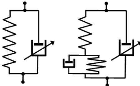
**Р и с. 1.** Реологические модели простого нелинейного контакта и контакта, заполненного флюидом
