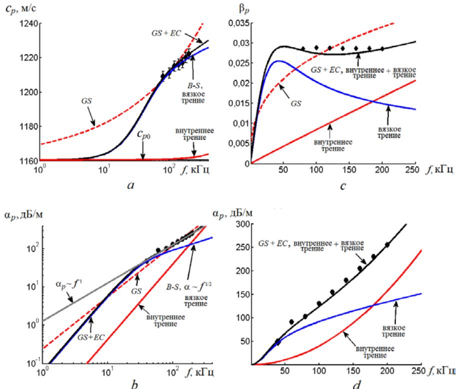
**Р и с. 3.** Частотные зависимости скорости звука (a), коэффициента затухания (b), тангенса потерь (c), затухания (d) и компонент трения. Эксперимент «стеклянные шарики в силиконовом масле» (a, b – логарифмические координаты; c, d – линейные координаты)
