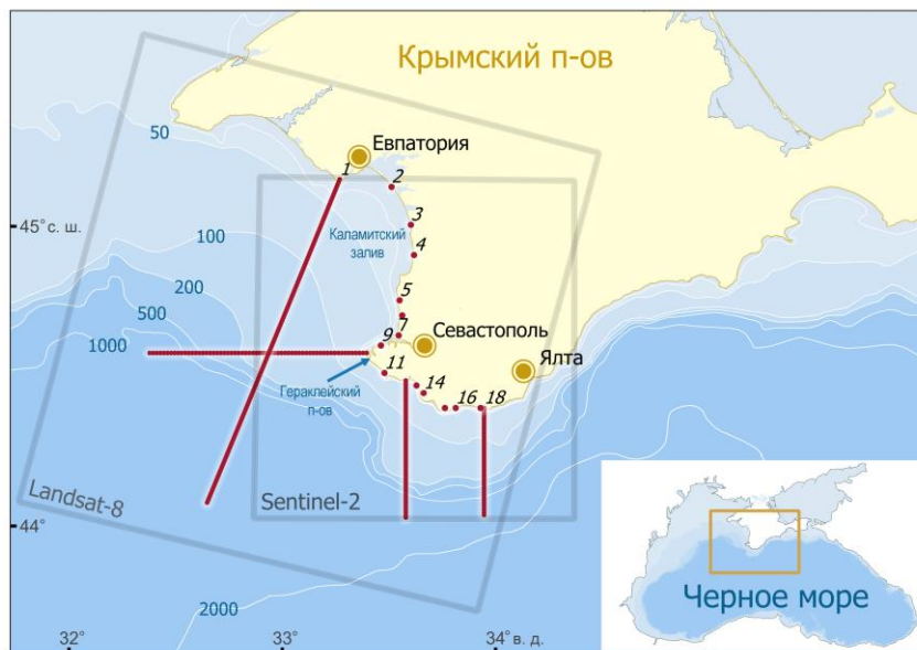
Р и с. 2. Батиметрия Черного моря вблизи Крымского п-ова. Тонкие белые контуры – 20-, 50-, 100-, 200-, 500-, 1000-, 2000-метровые изобаты; красные пронумерованные линии – некоторые разрезы, рассматриваемые в численных экспериментах (для остальных указаны только начальные точки); светло-серые прямоугольники – области доступности спутниковых данных
