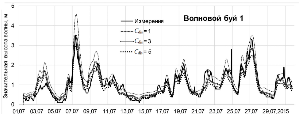
Р и с. 2. Зависимости значительной высоты волны от времени (1–31 июля 2015 г.) в точке расположения буйа 1 (ст. Pohjois-Itämeri ) по натурным данным и результатам расчета F i g. 2. Dependencies of a significant wave height upon time (1–31 July, 2015) at the location of buoy 1 (st. Pohjois-Itämeri ) based on the field data and simulation results
