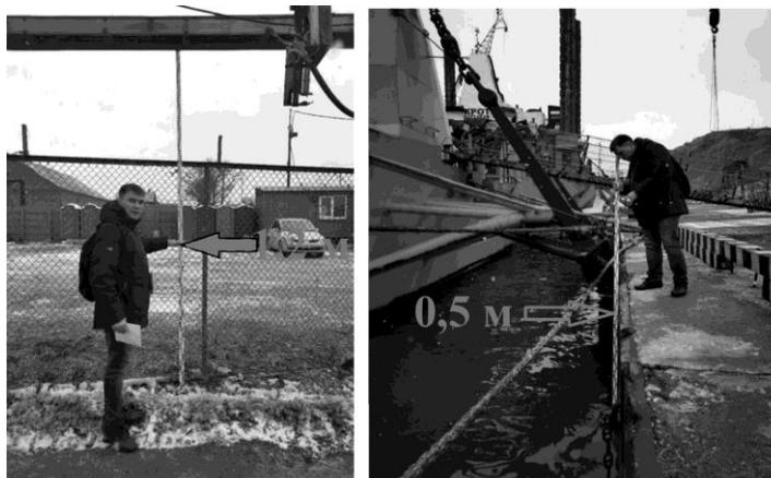
**Р и с. 3.** Измерение высоты наката от штормового нагона в порту г. Корсаков
