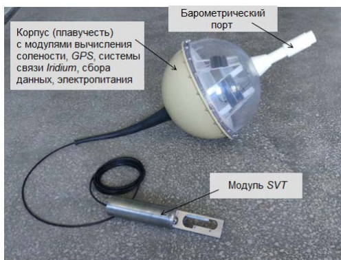
Р и с. 1. Внешний вид дрейфера с модулем SVT F i g. 1. Appearance of the drifter with the sound velocity and temperature module
