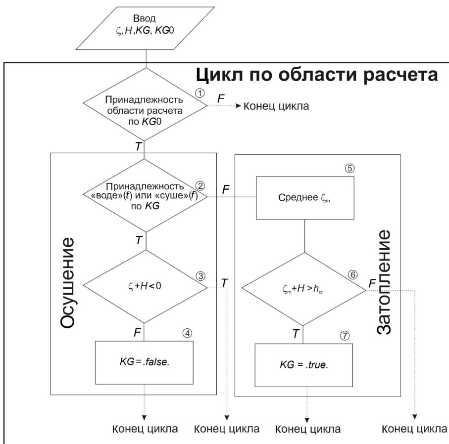
Р и с. 1. Блок-схема алгоритма расчета области затопления и осушения 4 Fig. 1. Block diagram of the algorithm for calculating the area of flooding and drainage 4
