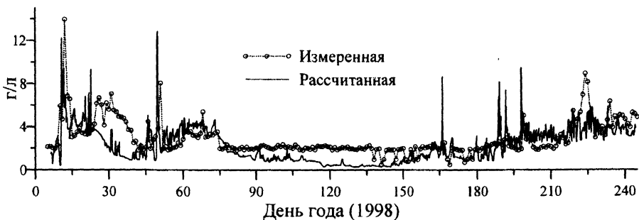
Р и с. 8. Рассчитанная по сценарию 1 солёность на глубине 1 м по сравнению с измеренной на ст. Очаков
