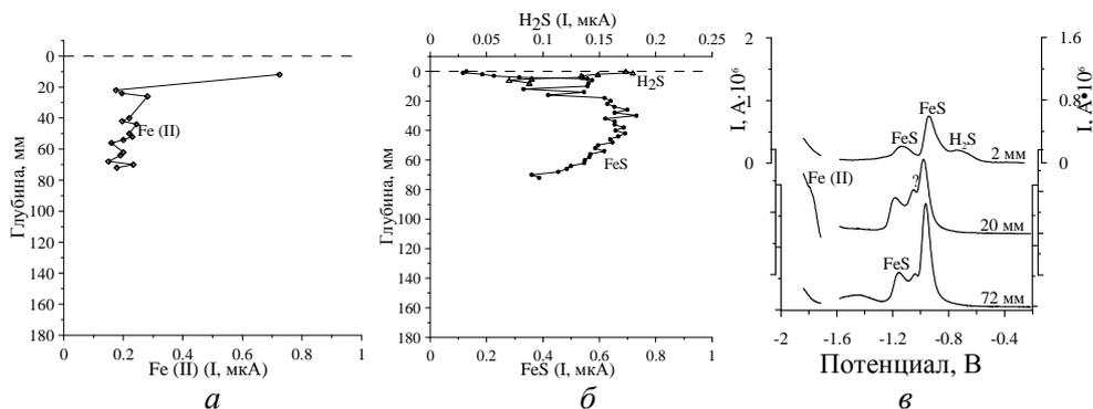
Р и с. 5. Вертикальное распределение Fe(II) – а, H<sub>2</sub>S, FeS – б и их сигналы на полярограммах – в (ст. 15)
