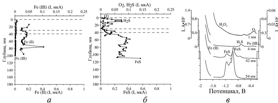
**Р и с. 2.** Вертикальное распределение Fe(II), Fe(III) – *a*, O<sub>2</sub>, H<sub>2</sub>S, FeS – *б* и их сигналы на полярограммах – *в* (ст. 17)
