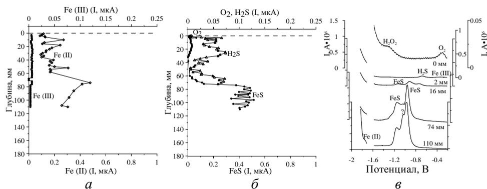
Р и с. 6. Вертикальное распределение Fe(II), Fe(III) – а, O<sub>2</sub>, H<sub>2</sub>S, FeS – б и их сигналы на полярограммах – в (ст. 12)
