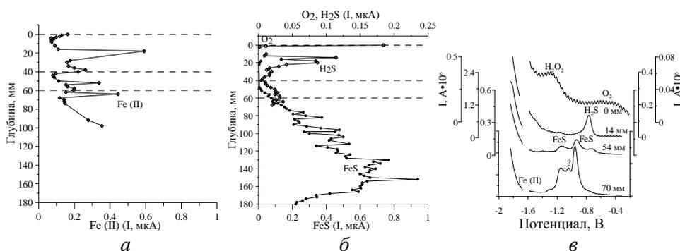
**Р и с. 4.** Вертикальное распределение Fe(II) – а, O<sub>2</sub>, H<sub>2</sub>S, FeS – б и их сигналы на полярограммах – в (ст. 23)
