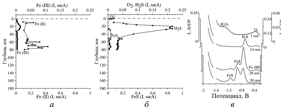
**Р и с. 3.** Вертикальное распределение Fe(II), Fe(III) – *a*, O<sub>2</sub>, H<sub>2</sub>S, FeS – *б* и их сигналы на полярограммах – *в* (ст. 19)
