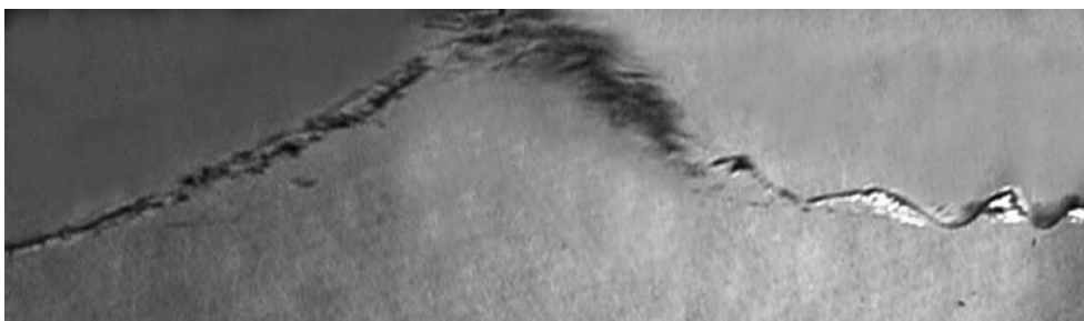
Р и с. 3. Ветровой солитон в кольцевом аэрогидроканале (на подветренном склоне видно затухание развивающихся волн; движение – слева направо)
