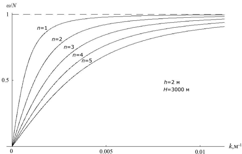
Дисперсионные кривые для внутренних волн Кельвина под ледяным покровом постоянной толщины  $h = 2$  м ( $n$  – номер моды; глубина океана  $H = 3000$  м; частота Брента – Вайсяля  $N = 0,001$  с $^{-1}$ )
