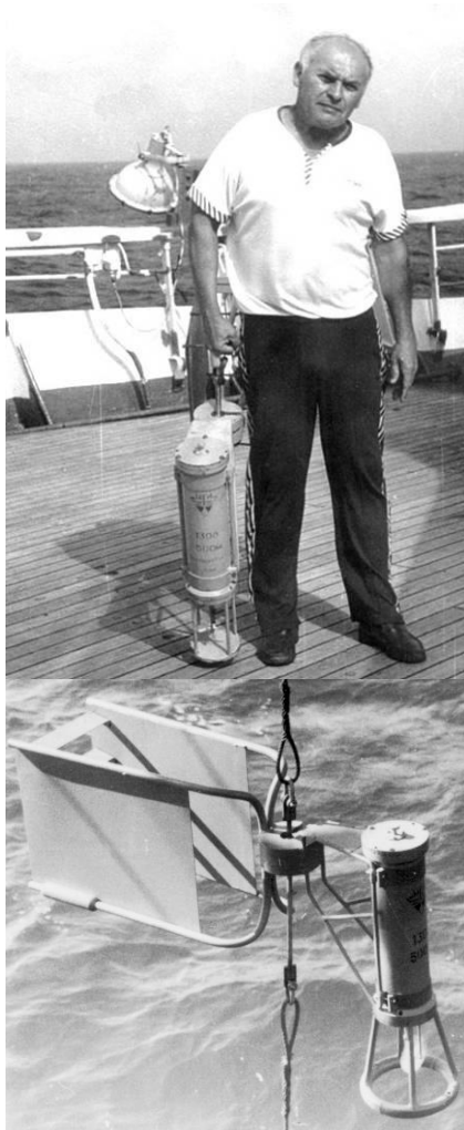
Рис. 8. Натурные испытания измерителя течений МГИ-1308 в 41-м рейсе НИС «Академик Вернадский», Атлантический океан
