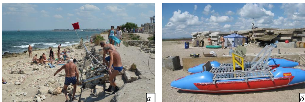
Рис. 14. Методы постановки комплекса «Донная станция»: вручную (пляж заповедника «Херсонес») – а; с помощью специально созданного плавсредства на базе надувного катамарана «Нерис» на о. Коса Тузла – б
