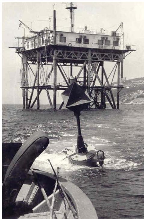
**Рис. 2.** Дрифтер МГИ-9301 с приемником РНС «Омега» и аппаратурой спутниковой системы связи ССПИ-ИК во время испытаний в районе океанографической платформы в пос. Кацивели
