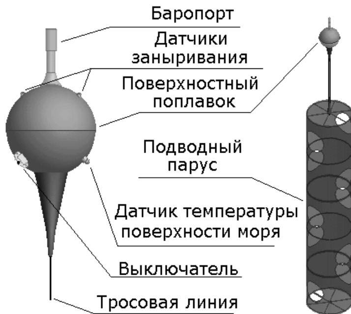
Рис. 6. Структура *SVP-B* дрейфующего буя
