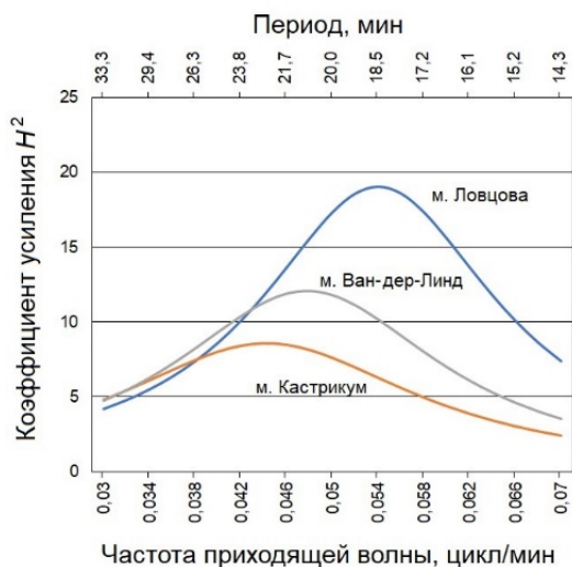
Р и с. 6. Зависимость коэффициента усиления приходящей волны от ее частоты Fig. 6. Dependence of the gain factor of an arriving wave upon its frequency
