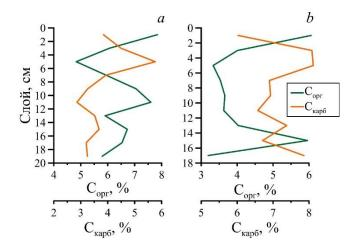
**Р и с. 2**. Вертикальное распределение  $C_{opr}$  и  $C_{kap6}$  в донных отложениях Стрелецкой бухты на ст. 27 (a) и 30 (b)
