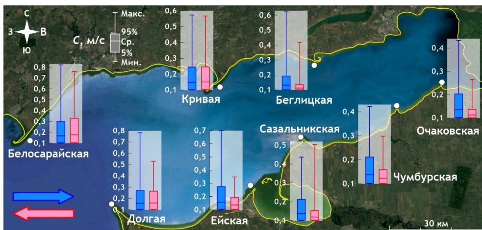
Р и с. 6. Статистические характеристики распределений скоростей придонных течений (м/с) за 1979–2020 гг.
