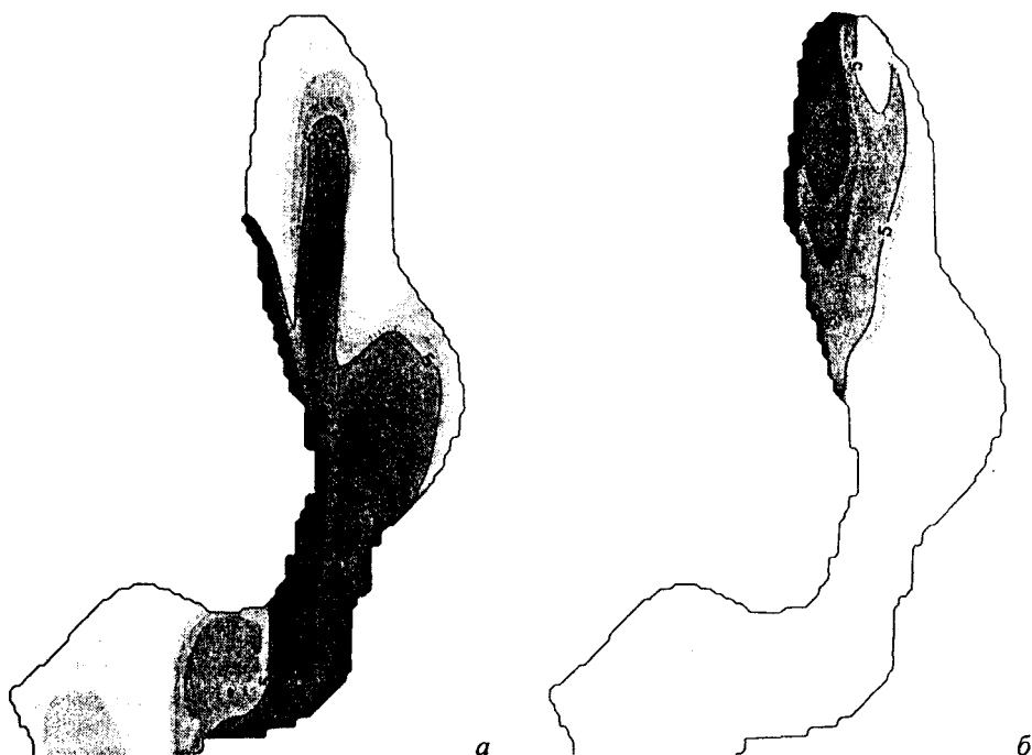
Р и с. 7. Распределение концентрации примеси на поверхности бухты при северном ветре после 5 ч (а) и при южном ветре после 8 ч (б) действия выпуска 2
