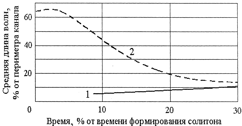
Р и с. 2. Влияние поверхностно-активных веществ на механизм зарождения ветрового солитона (1 — чистая вода, 2 — при наличии ПАВ)
