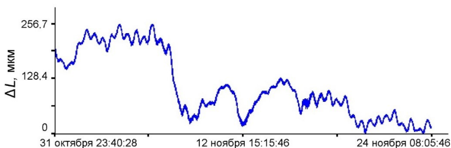
Р и с 4. Участок записи данных берегового лазерного деформографа за период 31 октября – 24 ноября 2025 г.
