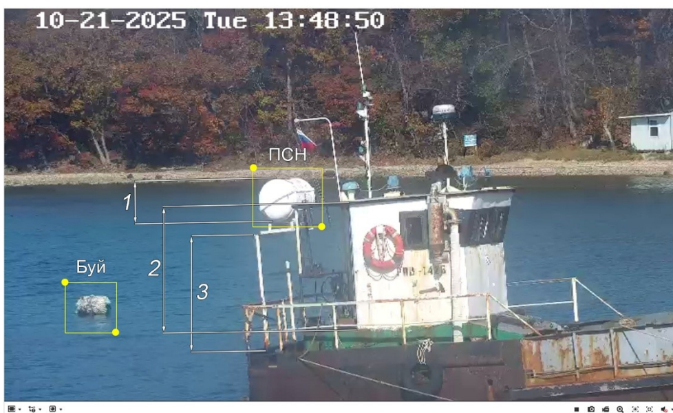
Р и с. 2. Кадр непрерывной видеорегистрации маркерных объектов в б. Алексева с элементами метрической калибровки изображения: 1 – диаметр спасательного пловца (ПСН); 2 – край конструкции рубки; 3 – левая вертикальная стойка
